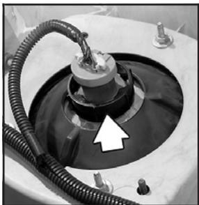
3. Tourner le dispositif de retenue de l'ampoule/ de la douille dans le sens contraire des aiguilles d'une montre pour déverrouiller l'ampoule/la douille.
