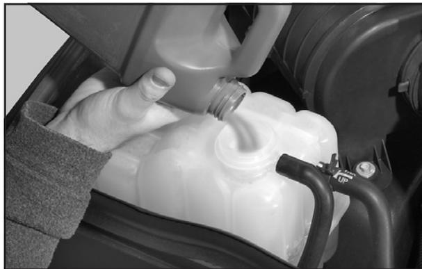
4. Remplir ensuite le réservoir d'expansion avec le mélange approprié jusqu'au repère FULL COLD (plein à froid).
