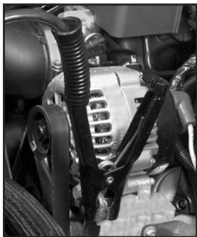
La borne négative (-) auxiliaire est située sur la bride de courroie d'entraînement des accessoires du moteur. Elle porte la mention GND (masse).
