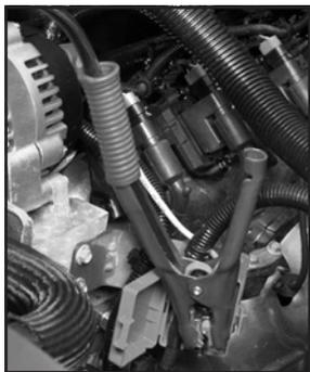
La borne positive (+) auxiliaire se trouve à proximité de la bride de courroie d'entraînement des accessoires du moteur. Sur certains véhicules, elle est recouverte d'un couvercle de plastique rouge. Pour accéder à la borne positive (+) auxiliaire, ouvrir ce couvercle, le cas échéant.
