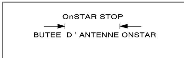
Si votre véhicule est équipé du système OnStar et de navigation, il comporte une patte d'arrêt de traverse, située dans le longeron, à l'endroit marqué OnSTAR STOP (arrêt du système OnSTAR). Cette patte vous évite de déplacer les traverses et la marchandise trop près de l'antenne OnStar, ce qui risquerait d'entraîner le dysfonctionnement ou l'arrêt du système.
