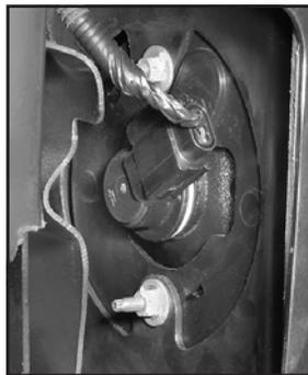
1. Repérer la lampe à l'arrière du pare-chocs avant. Il est plus facile d'entrer à partir du côté du véhicule, par l'ouverture de roue.
