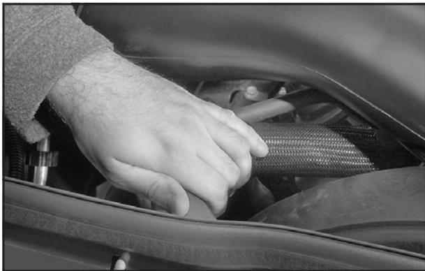
5. Sans remettre le bouchon de pression du réservoir d'expansion, mettre le moteur en marche et le laisser tourner jusqu'à ce que vous sentiez que la durite supérieure de radiateur commence à chauffer. Faire attention au ventilateur de refroidissement du moteur.
