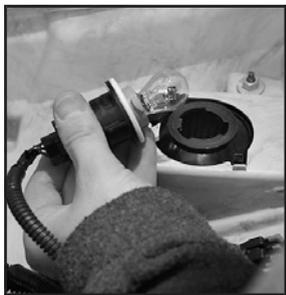
4. Retirer l'ampoule de sa douille.
